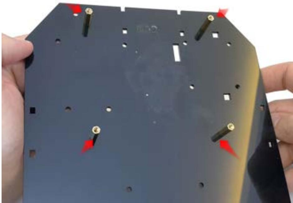
22. Adım: R02 kodlu parçayı R01 kodlu parçanın üzerine yerleştirin. Motorları çapraz olacak şekilde gruplandıracağız. Çapraz motorların kablolarını birlikte gruplayıp R02 kodlu parçanın deliklerinden geçirin.
