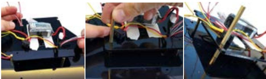
33. Adım: Şimdi elektronik modüllerimizi hazırlayıp R08 kodlu parça montajını yaptıktan sonra gövdemizin en üstüne yerleştireceğiz. Arduino Nano'yu sensör shield'a yerleştirelim. Ardından M3x10 mm vidaları deliklerinden geçirip alt tarafından M3 somunları sonuna kadar geçirelim. Bu somunlar R08 ile Shield arasında aralayıcı vazifesi görecek.
