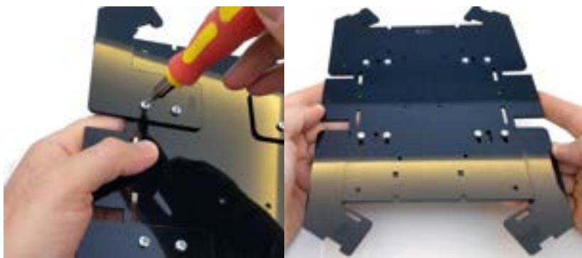
16. Adım: Motorları R09 nolu parçaya monte edeceğiz. R03 kodlu parçalardan birini motora M3x30 mm vida ile yerleştirin.
