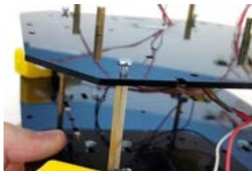
24. Adım: R04 kodlu parçayı çapraz bir şekilde ön taraftan sokup alt ve üst dişlerin R01 ve R02 parçalarındaki deliklere oturtun. Aynı işlemi diğer R04 kodlu parça için de gerçekleştirin.
