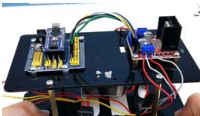
40. Adım: NRF24L01 modülünün kablo bağlantılarında aşağıdaki tabloya göre 10 cm'lik dişi dişi kablolar ile yapıp şasının uygun bir noktasına elektrik bandı ile sabitleyin.
